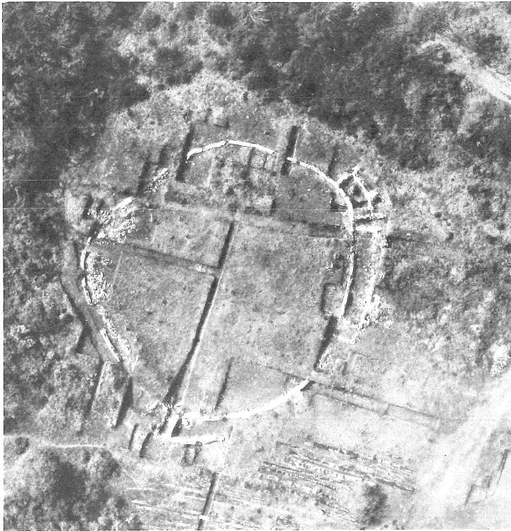
Abb. 4c: Orthophoto, hergestellt aus einer RC10-Aufnahme (1980) mit Hilfe des Wild OR1/SORA-OP Systems. Dasselbe DEM wie in 4a und 4b wurde verwendet.
