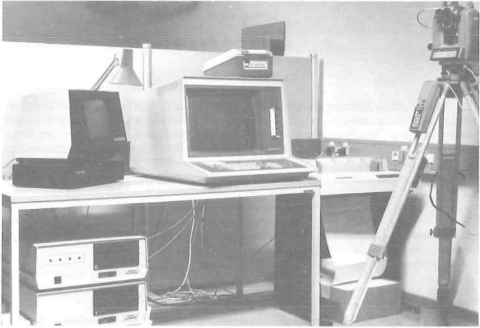
Datenerfassungssystem WILD T 2000/DI 4L/GRE 3 und interaktiv-graphisches WILD Auswertesystem GEOMAP. (Abt. Ingenieurgeodäsie)
