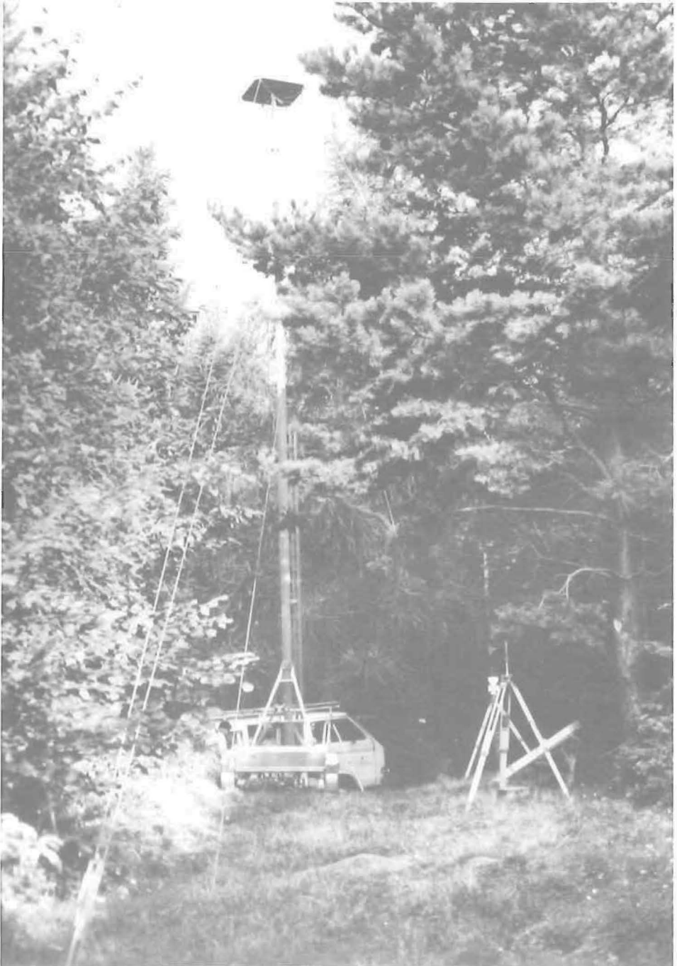
Abb. 1: Punkt 1. Ordnung Ringkogel Macrometer-Antenne auf Signalmast der Abteilung Festpunktfeld des BEV
