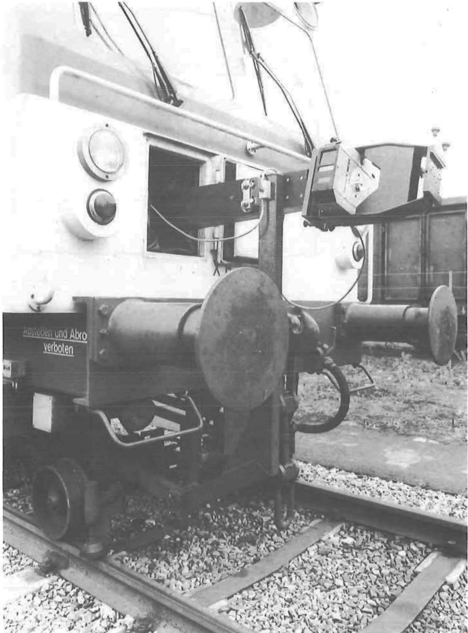
Bild 3: Das Impulslasersystem RIEGL DM 900 in Querprofil-Arbeitsstellung.
