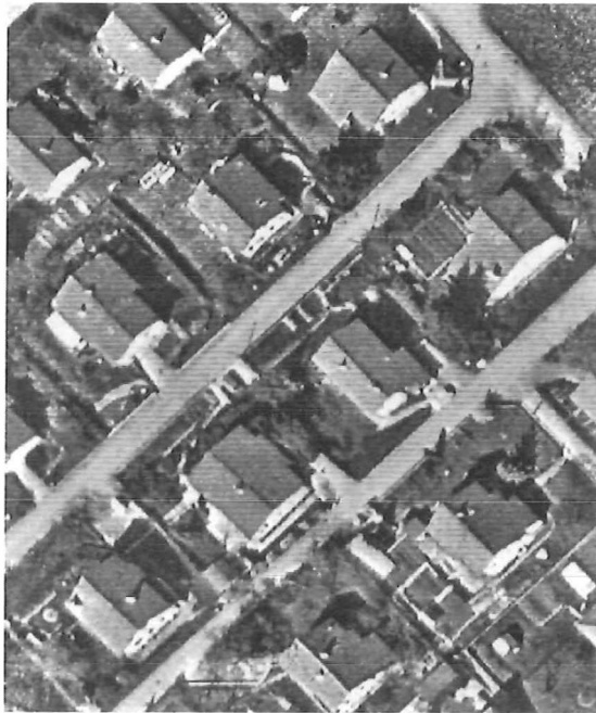
Abb. 10a: Unkorrigiertes Orthobild. Die Häuser erscheinen „umgeklappt“
