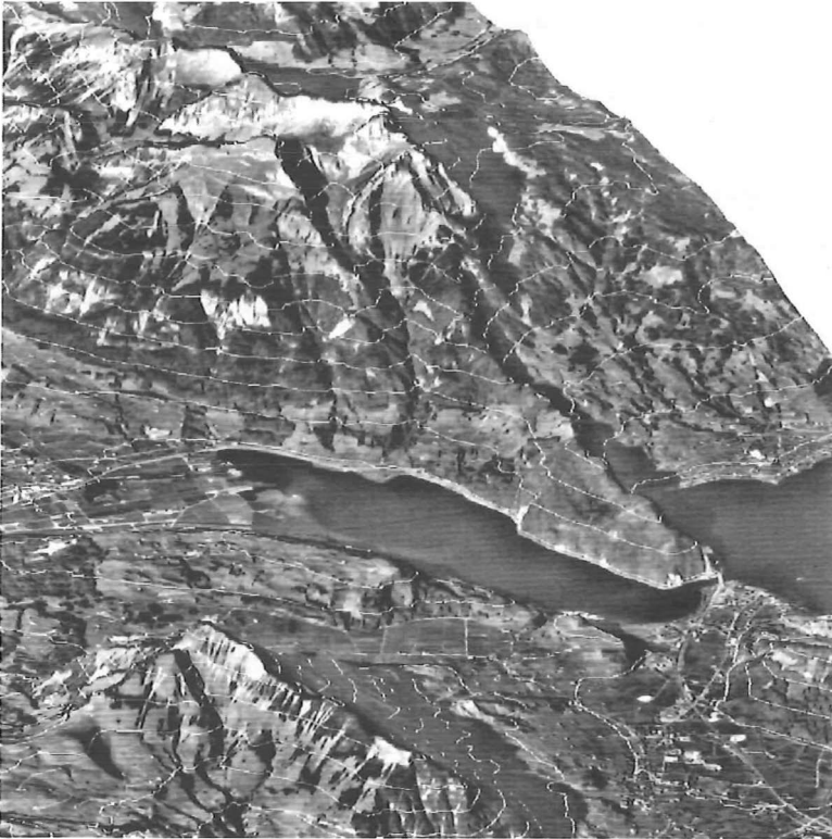
Abb. 9: Überlagerung DTM - SPOT-Orthobild, mit Höhenlinien (DTM: Bundesamt für Landestopographie, Bern)
