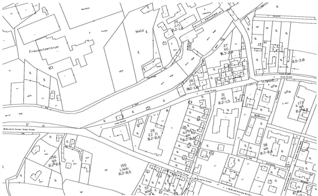
Abb. 1: Digitaler Kataster als Grundlage für den Flächenwidmungsplan der KG Feldbach, Originalmaßstab des Plots 1:5,000 (mit freundlicher Genehmigung des Vermessungsbüros Reichthaler)
