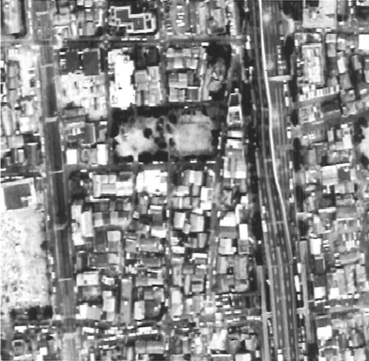
Abb. 1: Vergleich der Aussagekraft von 1 m und 10 m Pixeln anhand eines simulierten Datensatzes aus Luftbildern der Erdbebenschäden 1995 in Kobe/Japan. (Space Imaging, 1995).
