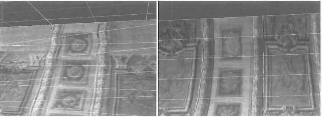
Abb. 3: Verschiedene Facettierung im Bereich des Tonnengewölbes und damit verbundene Qualitätsverluste bei der photorealistischen Textur (langgestreckte Dreiecksflächen bewirken sichtbare Projektionsfehler durch die affine Transformation perspektiver Bilddaten)
