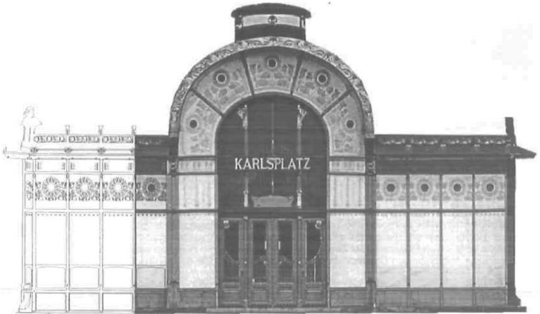
Abb. 1: Massische (Strichauswertung) und digitale Version (Orthobild) eines Fassadenplans
