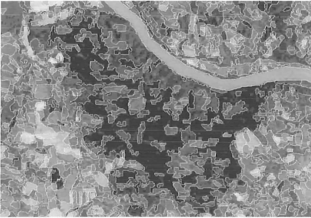
Abbildung 3: Ergebnis einer Segmentierung eines Landsat TM Bildes hinterlegt mit dem Ausgangsbild (Farbkomposite 4-3-2)
