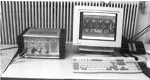
Abb. 3: ISEL-Schrittmotorsteuerung für die Bewegung der Kamera und des Meßobjekts (links). Monitor zur Überwachung des Aufnahmevorgangs (rechts).
