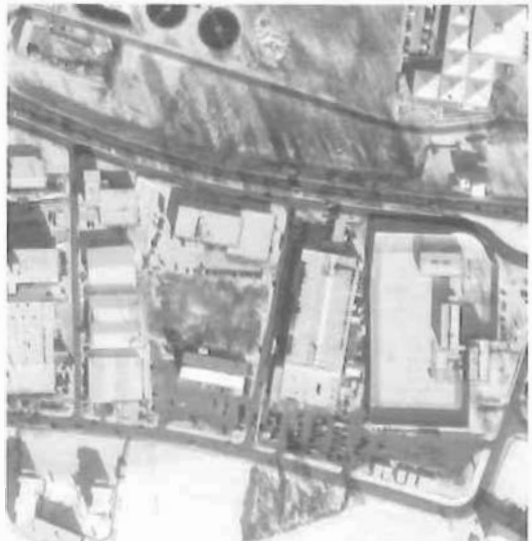
Abb. 3: Die Winteraufnahme von IKONOS einer Ortschaft in Bayern zeigt die gute radiometrische Qualität (Grauwertabstufung ueber einen weiten Dynamikbereich) der Daten. Copyright: Space Imaging Europe, Distribution Umweltdata Ges.m.b.H.
