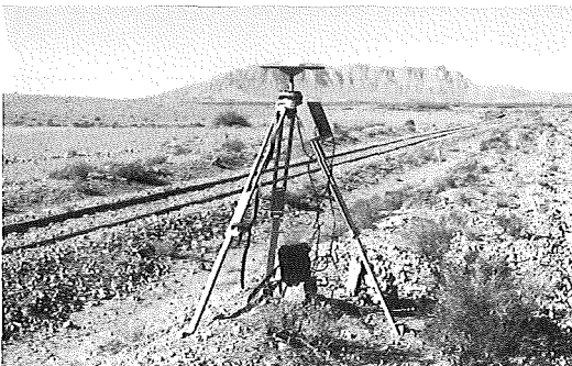
Abb. 2: GPS-Empfänger auf Punkt des Hauptnetzes
