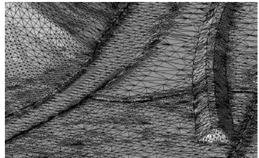
(b) Adaptives TIN, hierarchische Unterteilung, \Delta z_{\max} = 25\text{cm} , Reduktionsrate: 83%.
