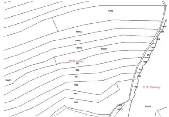
Abb.2-1: Ausschnitt KG. Jakling, links Urmappe 1826 (schwarz), Neuaufnahme 1933 (rot); Abb.2-2: rechts aktueller Stand 2007
