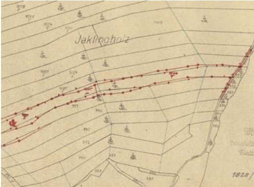
Abb.2-1: Ausschnitt KG. Jakling, links Urmappe 1826 (schwarz), Neuaufnahme 1933 (rot); Abb.2-2: rechts aktueller Stand 2007
