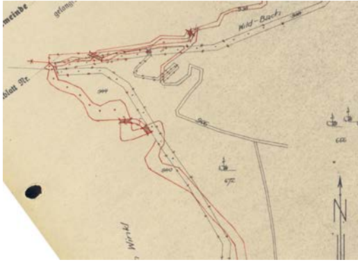
Abb.1-1: Ausschnitt KG. Zell bei der Pfarre, links Urmappe 1826 (schwarz), Neuaufnahme 1931 (rot); Abb.1-2: rechts aktueller Stand 2007
