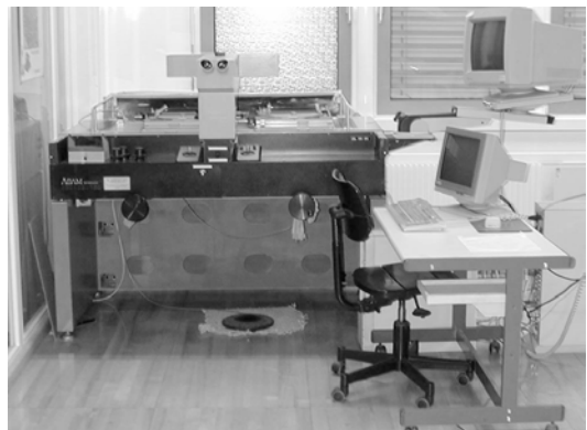
Abb. 13: Improvisation eines analytisch-photogrammetrischen Auswertegeräts per Umbau eines Zeiss-Topocart mittels elektronischem Bausatz der Fa. Adam (Australien)
