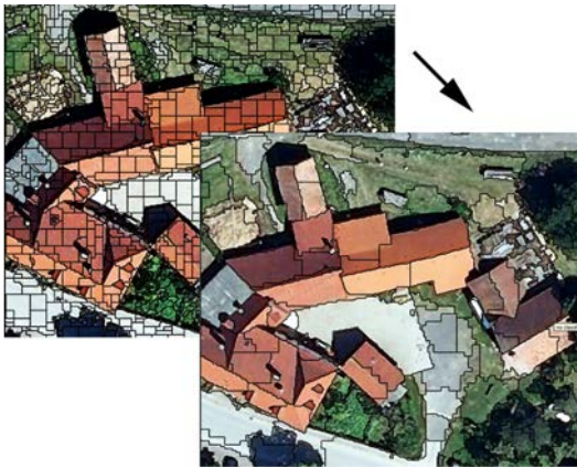
Abb. 2: links: Quadtree Segmentation, rechts: Segmentierung mit PPOs
