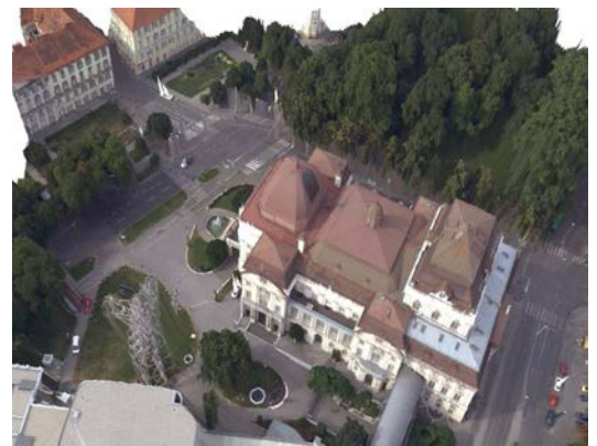
Abb. 8: 3000 Luftbilder von Graz aus der UltraCam digitalen Luftbildkamera. Die Triangulierung liefert eine dünne Punktwolke (25.000 Punkte pro km 2 ) und die Kamerapositionen mit Orientierungswinkeln (oben). Unten ist das Ergebnis der Berechnung der dichten Punktwolke zu 100 Mio. Punkten pro km 2 , in diesem Falle mit der Phototextur überlagert (Grazer Opernhaus). Aus Leberl u.a. (2010).
