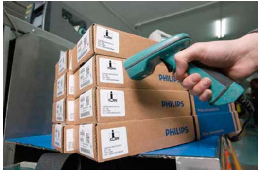
Abb. 4: Lesegerät zur Erfassung der auf einem RFID-Chip gespeicherten Objekt-Information in verpackten Waren.
