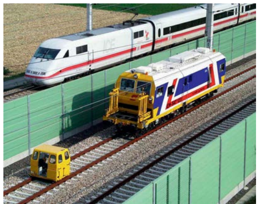
Abb. 3: EM-SAT 120; links in gelb der sogenannte Satellit
