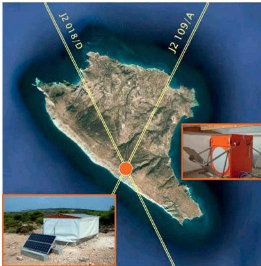
Abb. 5: Die Transponderstation und ihre Position auf Gavdos am Kreuzungspunkt von Jason-2
