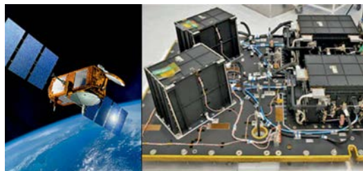
Abb.4: Jason-2 (links) und Poseidon-3 Altimeter (rechts)
