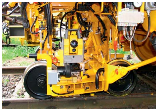
Abb. 5: Festpunktmessgerät auf EM-SAT 120
