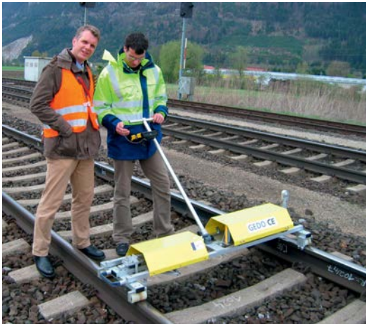
Abb. 7: Sinning Gedo CE; Gleismesswagen mit Prisma (rechts am Wagen) und Feldkontroller
