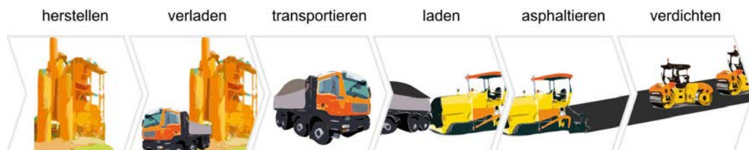
Abb. 1: Prozesskette beim Asphaltstraßenbau [1]
