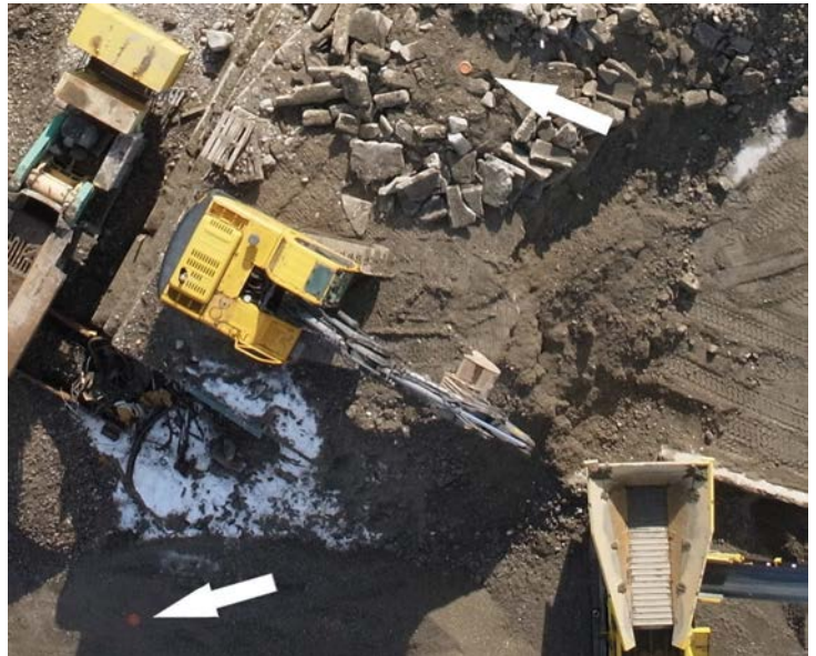
Abb. 4: Luftbildausschnitt mit künstlichen Passpunkten
