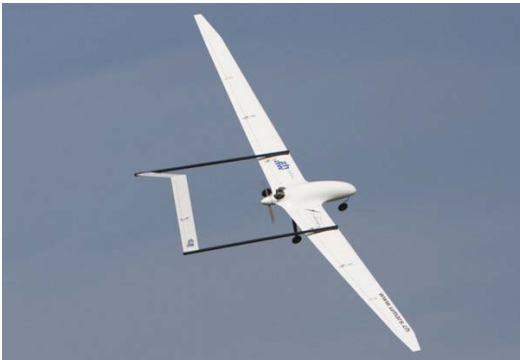
(e) Flächenflugzeug (Spannweite: 5 m) http://www.zhaw.ch/de/engineering/institute-zentren/zav/unsere-projekte/projekt-umars.html
