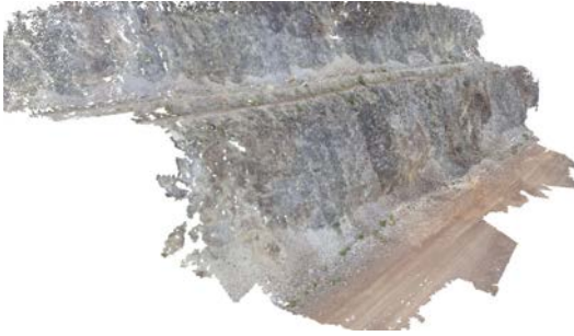
Abb. 4: Die durch PMVS2 [10] verdichtete Punktwolke besteht aus etwa 10 Millionen 3D Punkten
