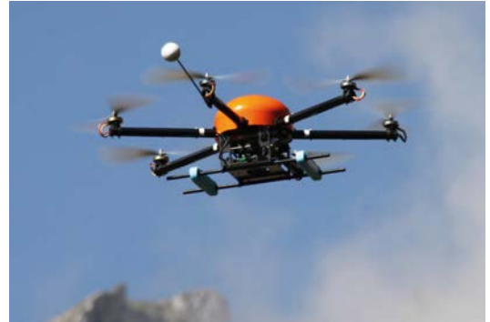
Abb. 1: Hexakopter bestückt mit Ricoh-GXR Kamera. Flugzeit: 30 Minuten (Foto: GRID-IT)
