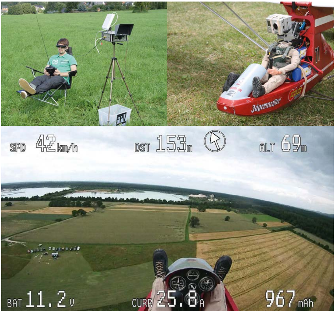
Abb. 2: Immersionsflug bzw. FPV (firstpersonview); Links Oben: Pilot mit Videobrille und Empfangsequipment; Rechts Oben: UAV mit Videokamera am Kopf der Pilotenpuppe; Unten: Livebild mit Sensordaten; Bildquelle: http://fpv-community.de/ .
