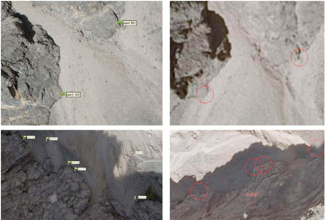
Abb. 4: Auf der Suche nach den Passpunkten; im UAV-Luftbild (links) und im 2009er Orthofoto (rechts)
