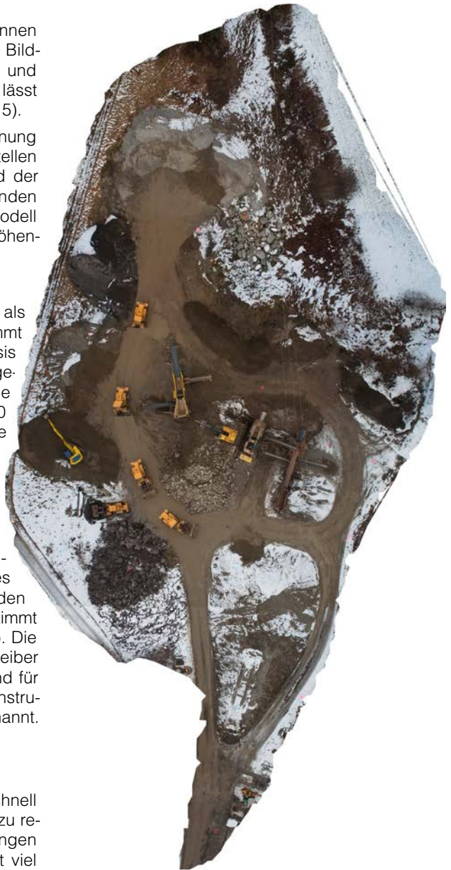
Abb. 5: Ausschnitt des aus 21 Einzelbildern erzeugten Orthophotos mit 5 cm Bodenauflösung
