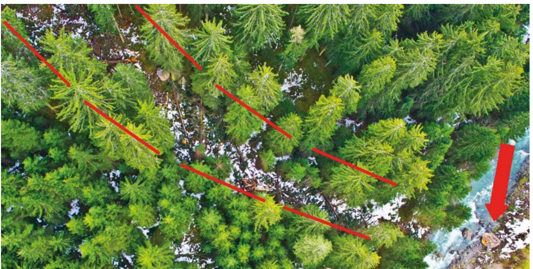
Abb. 2: UAV-Luftbilddokumentation des Felssturzereignisses im Oktober 2012. Ein Fels (mit Pfeil gekennzeichnet) markiert die beim Sturz verursachte Waldschneise.
