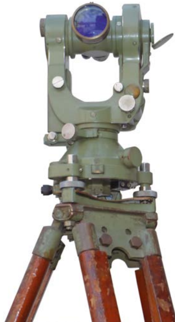
Abb. 7: Theodolit Wild T2 aus 1956, Einsatz bis in die 1990er Jahre
