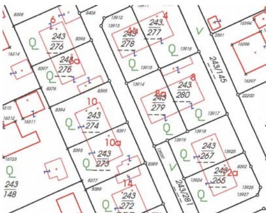
Abb. 3: Eigentumsstruktur als Netzwerk von Linien (Grenzen) und Knoten (Grenzsteinen). Quelle: DKM (BEV).
