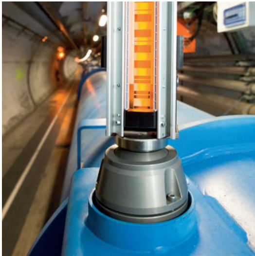
Abb. 4: Hunderte von gelben LEDs bestrahlen die Oberfläche im 45°-Winkel von links und rechts. Der Strom dafür kommt aus einem Akku, der je nach Barcode und Länge der Latte fünf bis zehn Stunden hält. (Quelle: CERN)
