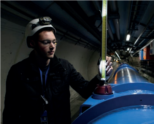
Abb. 2: In den seltenen, kurzen Wartungsphasen zwischen den Experimenten müssen die Magnete nachgemessen und neu ausgerichtet werden. Die inhomogene Beleuchtung führt hierbei jedoch häufig zu Fehlern oder Verzögerungen. (Quelle: CERN)
