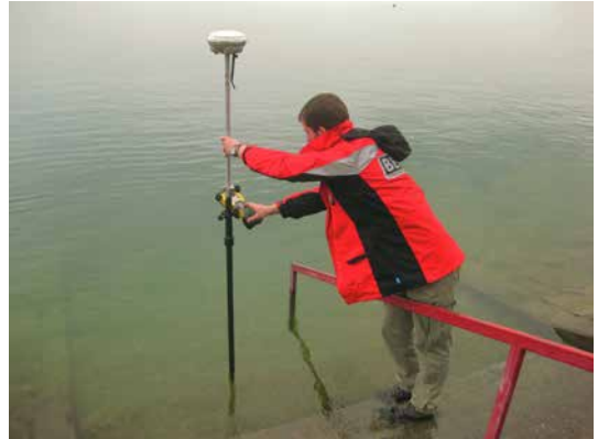
Messung von Kontrollflächen und -profilen durch Mitarbeiter des BEV
