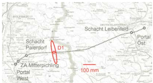
Abb. 10: Durchschlagsfehler beim KAT
