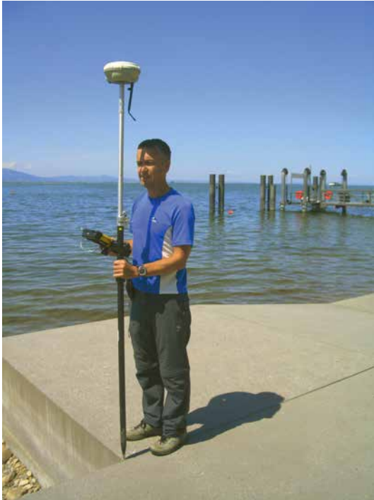
Messung von Kontrollflächen und -profilen durch Mitarbeiter des BEV
