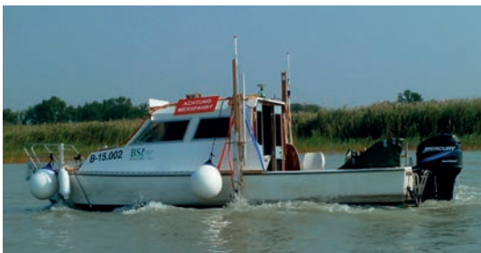
Abb. 3: Messboot mit Echolotaufbauten (links), Arbeitsplatz Messboot (rechts)
