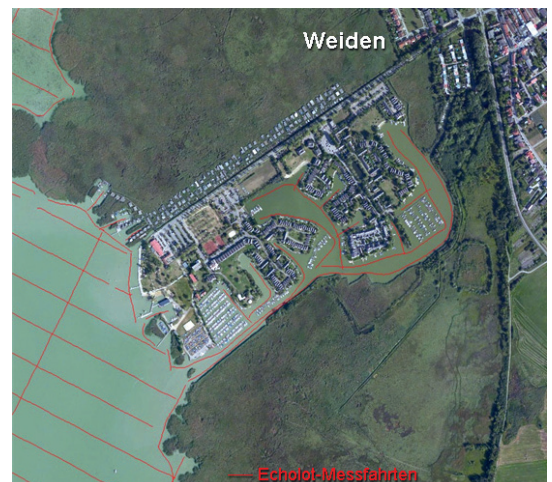
Abb. 4: links: 2.000 km Echolot-Messfahrten inkl. Kalibrierpunkt (CSPS); rechts: Messfahrten Detailansicht: Seepark Weiden
