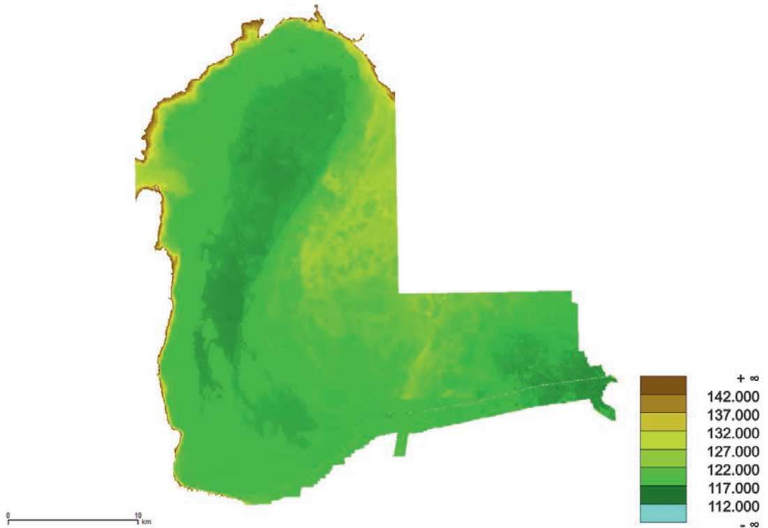
Abb. 12: Finales Modell der Sedimentoberkante im Bereich des Neusiedler Sees und des Einser Kanales erstellt aus den Echolot-Daten, den Einzelpunktmessungen und ALS-Daten.
