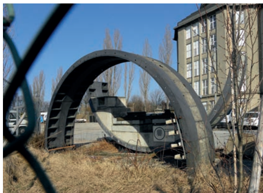
Abb. 11: Am Gelände verrostendes Streckentübbing der Wiener U-Bahn
