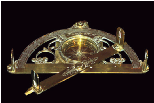
Abb. 13: Graphometer wurden auch mit einem Kompass kombiniert, um z. B. in bewaldetem Gebiet messen zu können; hier ein Butterfield compass Graphometer 49) aus Paris mit einer festen und einer beweglichen Visier-einrichtung für Richtungsmessungen
