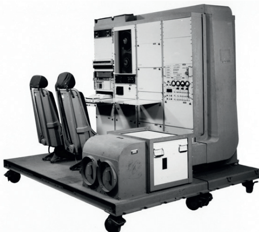
Abb.8: Eine der ersten GPS-Empfangsstation aus dem Jahr 1977 (Quelle: http://galileognss.eu/first-gps-signal-received-40-years-ago/ )
