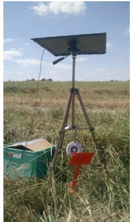
Abb.19: Eine selbstgebaute GNSS Referenzstation für GPS-Korrekturdaten (Quelle: StephaneP, https://goo.gl/4dt53k )
