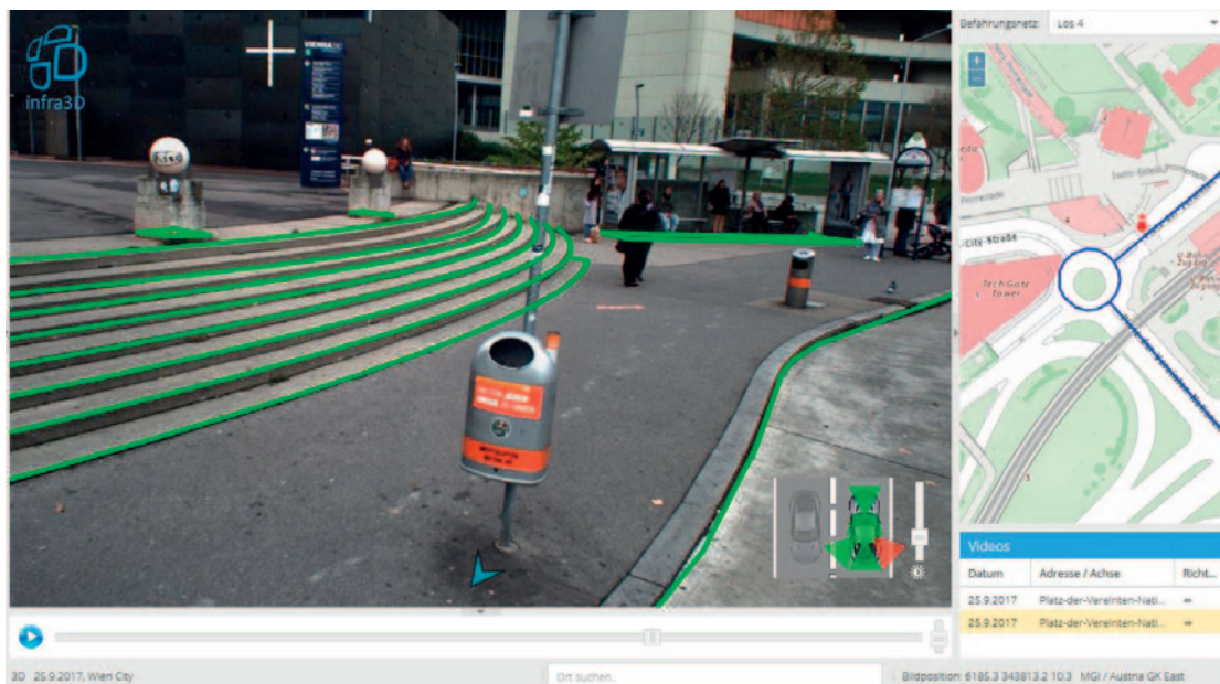
Abb. 4: Visuelle Kontrolle der Genauigkeit der Georeferenzierung anhand der Linien der Mehrzweckkarte der Stadt Wien. Die 3D Linien sind per Augmented Reality in den Bilddatendienst in grüner Farbe eingespiegelt. Bild Copyright: MA41 / Stadt Wien.
