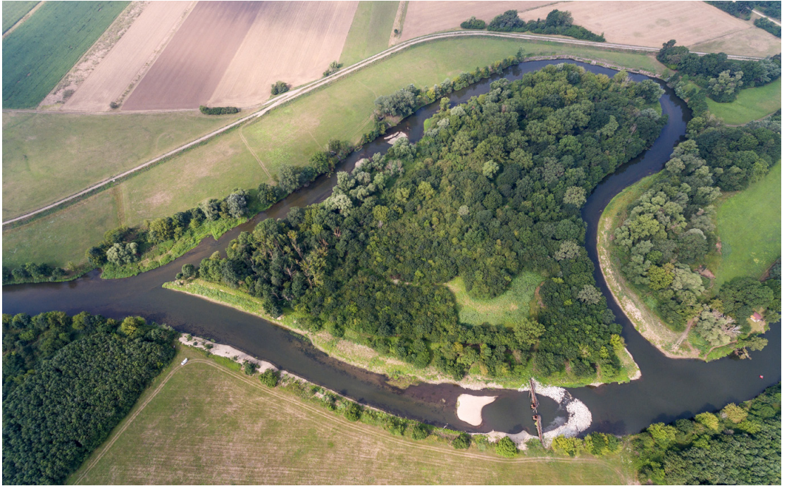
Abb. 21: Durchstich 18, Fertig angebundener Mäander am 31.07.2019
