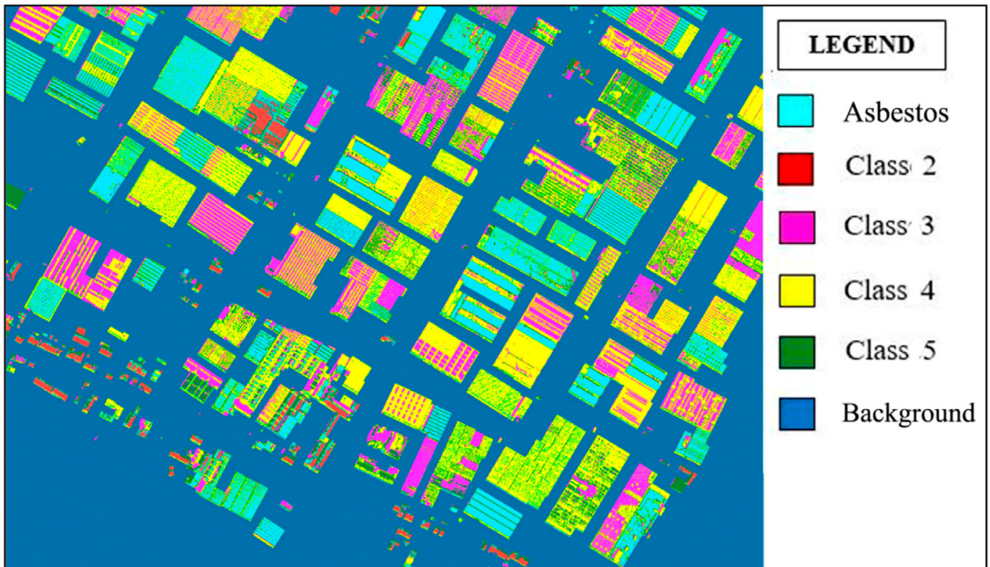
Abb. 11: Automatisch als mit Asbest bedeckte Dächer (Quelle: Maurizio Tommasini, Alessandro Bacciottini and Monica Gherardelli – A QGIS Tool for Automatically Identifying Asbestos Roofing, https://bit.ly/3acvKLd )
