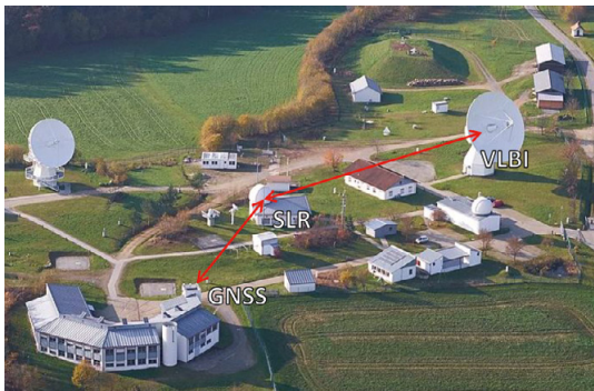
Abb. 1: Local ties (rote Pfeile) verknüpfen die Referenzpunkte geodätischer Instrumente auf Deutschlands Fundamentalstation in Wettzell
