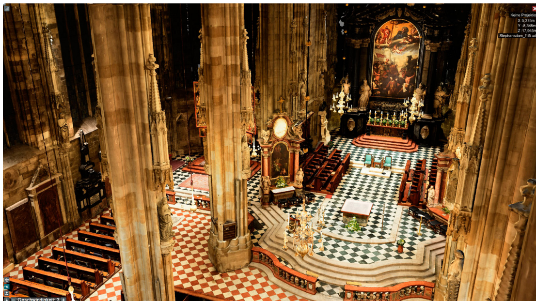
Abb. 6: Trianguliertes und texturiertes Modell, erstellt in der Software Euclidean
