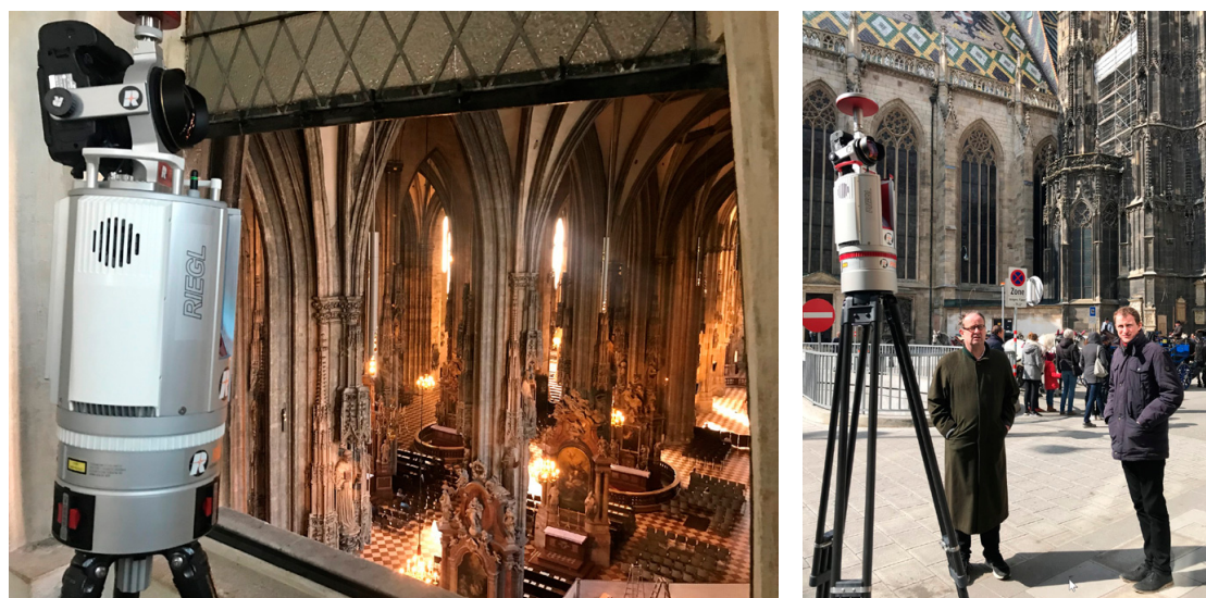
Abb. 1: Vermessung des Wiener Stephansdoms mit einem terrestrischen Laserscanner RIEGL VZ-400i
