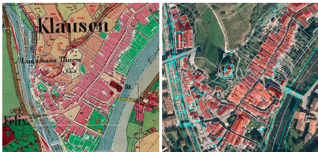
Abb. 3: Neupositionierung der Katastermappe in Klausen (Russo, 2016) – links Vergleich von neuem und altem Stand, rechts Vergleich von neuem Stand und Orthophoto
