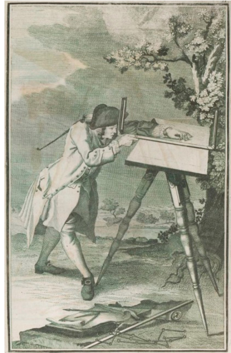
Abb. 8.1: Der Marinoni'sche Messtisch im Einsatz; aus „ De re ichnographica “, 1751, Bild 11.
