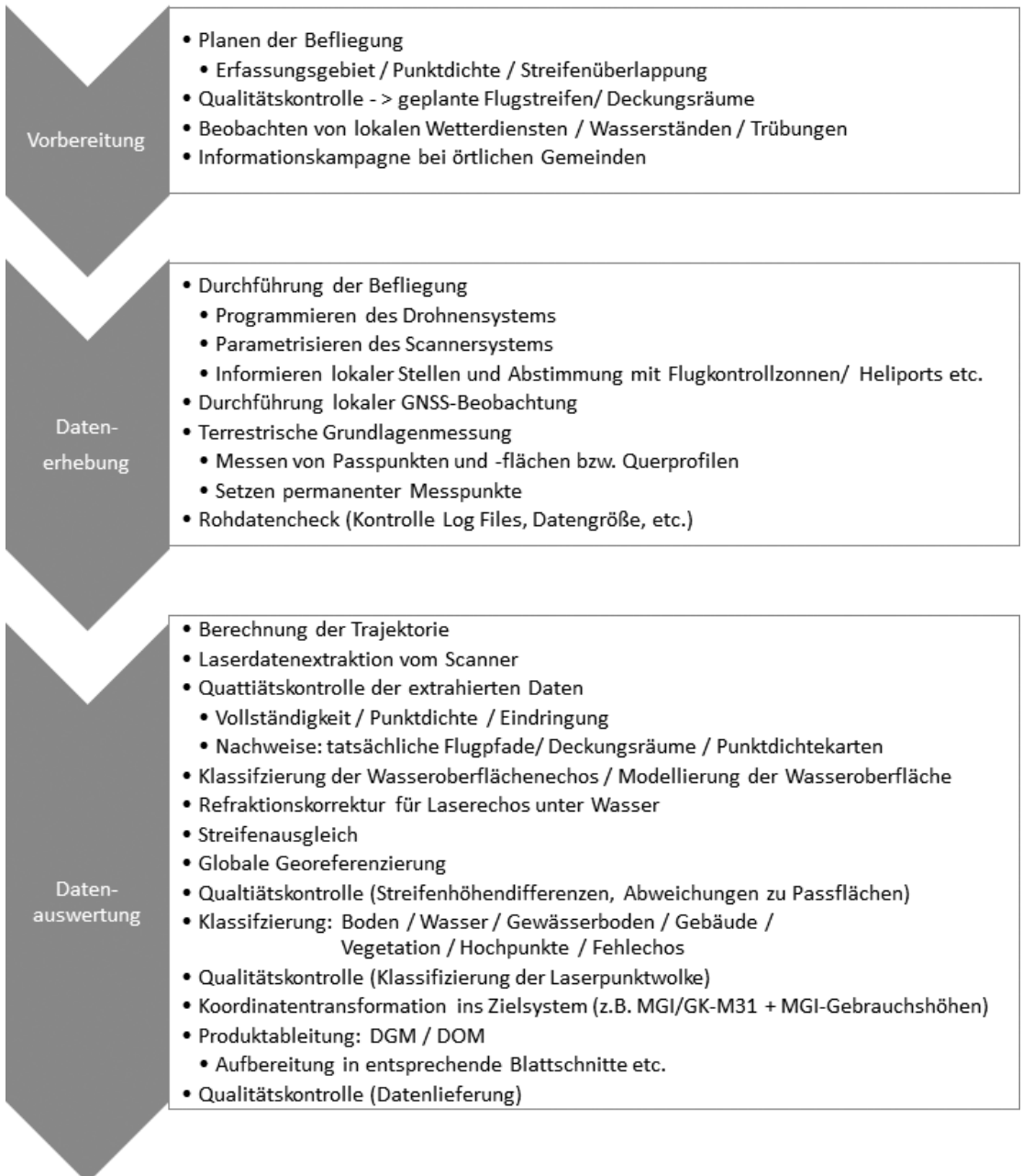
Abb. 3: Workflow einer topo-bathymetrischen UAV- Laserscanning Messkampagne
