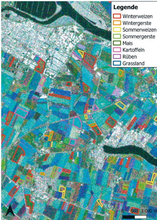
Abb. 4: Beispiel für eine Klassifikation landwirtschaftlicher Flächen basierend auf Sentinel-1 Zeitserien mittels eines Neuronalen Netzwerkes [30]
