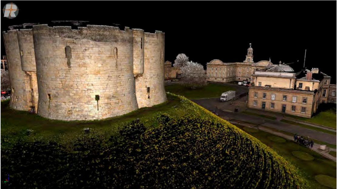
Eingefärbte Punktwolke des „Clifford's Tower“ in York, UK; 63 Scanpositionen in 60 Minuten; Aufnahmen vom 15. März 2023
