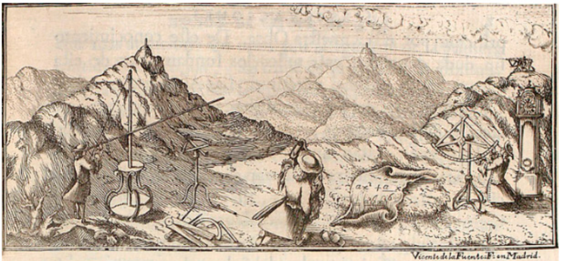
Abb. 13: Triangulation in Ulloa, Juan: „medir algunos grados de meridiano terrestre, y venir por ellos en conocimiento de la verdadera figura, y magnitud de la tierra“
