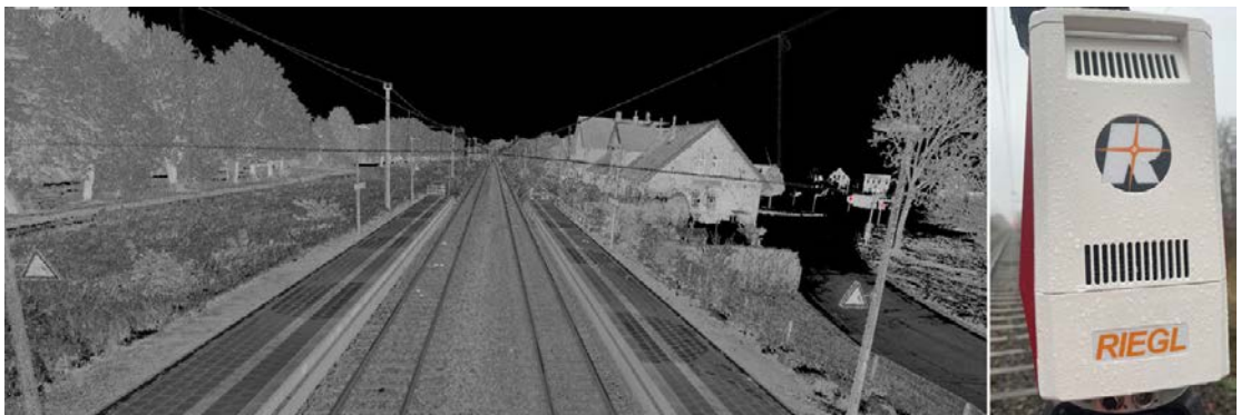
Abb. 5: Punktwolke einer Bahnstrecke; die bewegten Ziele wurden automatisch eliminiert
