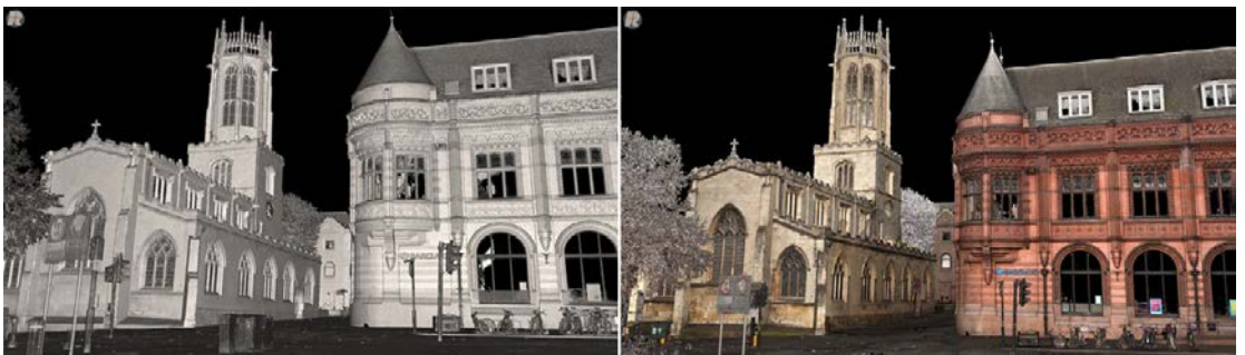
Abb. 7: Detailansicht links: grauschattierte Punktwolke (Reflectance), rechts: eingefärbte Punktwolke
