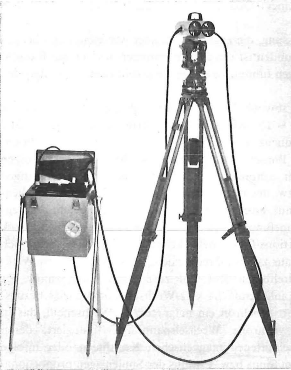
Abb. 1, Zielkopf des DI 10 auf dem Theodolit T2 adaptiert, mit Meßteil
