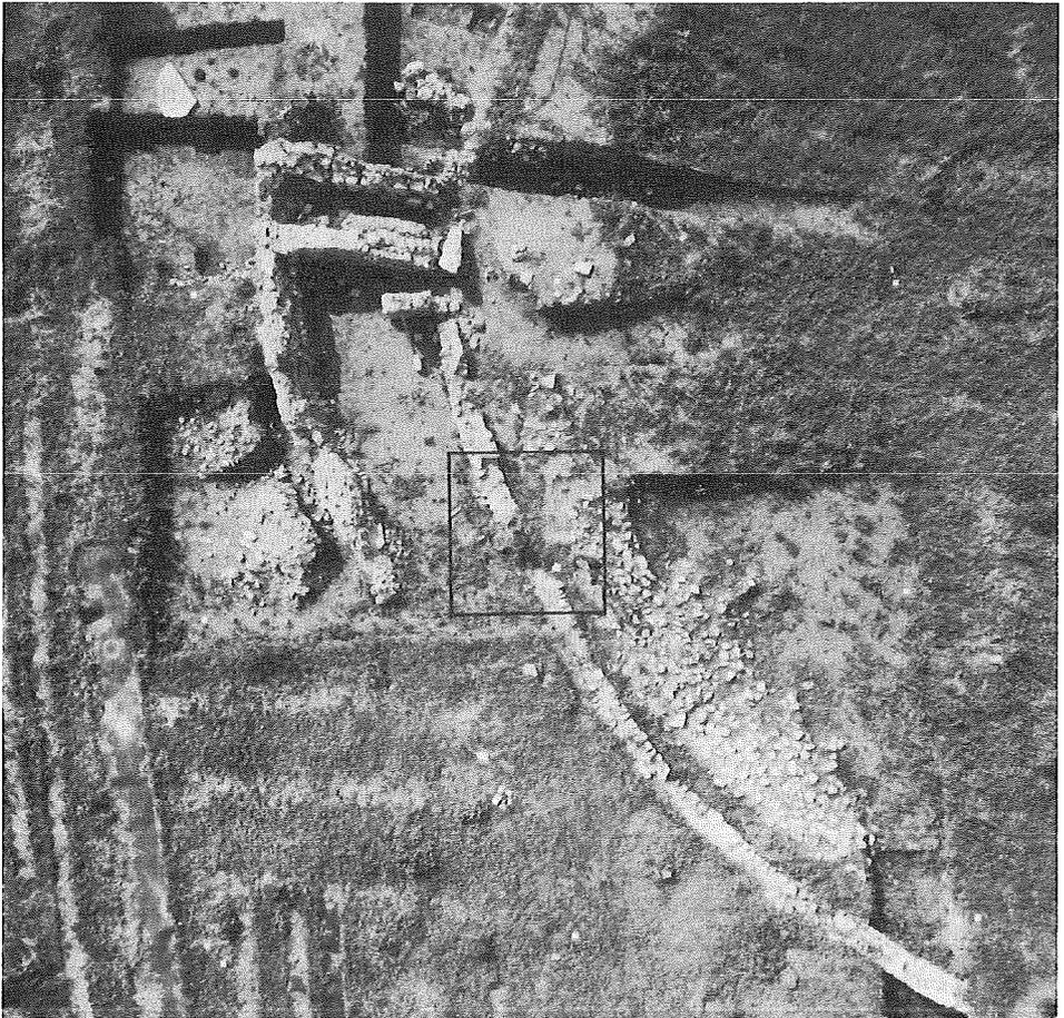
Abb. 7 Ballonaufnahme archäologischer Ausgrabungen auf dem Pfaffenberg aus 20 m Flughöhe. Das im Zentrum eingetragene Quadrat gibt den Nadirdistanzbereich für  $\varphi$  bzw.  $\omega$  von 5 gon an. Das mittlere der neun abgebildeten Paßpunktsignale liegt innerhalb dieses Quadrates, womit die Aufnahmen auch analog ausgewertet werden können.
