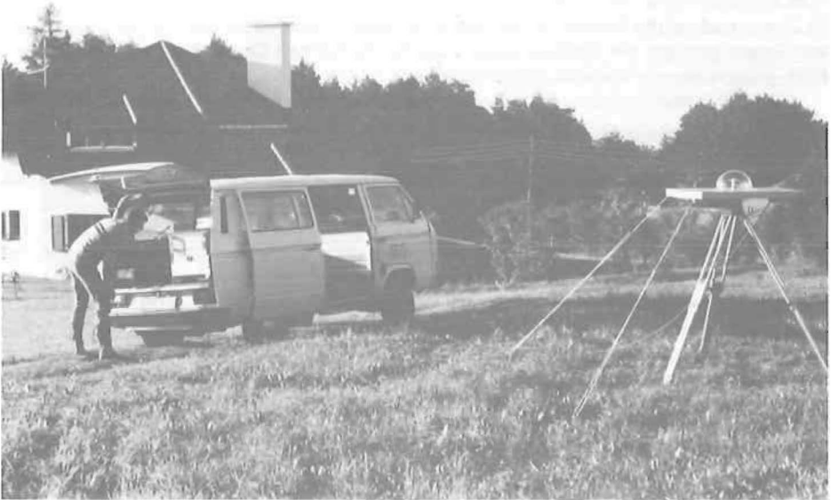
Abb. 2: Macrometer V-1000; Antenne und Elektronikeinheit in VW-Kombi
