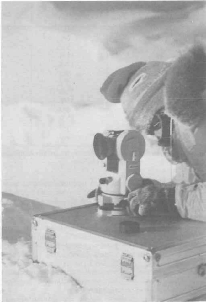
Figur 2: Bautheodolit Nikon NT-1S im Einsatz
