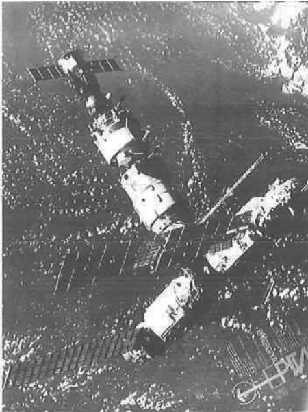
Abb. 2: Die Raumstation MIR: Senkrecht das Basismodul mit „Kwant“ und andocktem Raumschiff Sojous-TM; links „Kristall“ und rechts „Kwant-2“.
