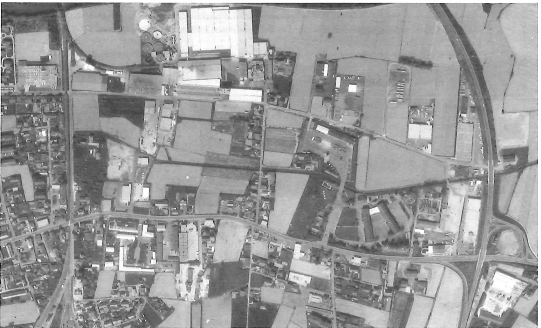
Abb. 4: Korrespondierender Luftbildausschnitt im Maßstab ca. 1:10,000 aus Flugprojekt KF 192-193 aus dem Jahr 1992 (Originalmaßstab ca. 1:30,000, Reihenmeßkammer RC-10). Vervielfältigt mit Genehmigung des Bundesamtes für Eich- und Vermessungswesen (Landesaufnahme) in Wien, Zl. L70173/94.
