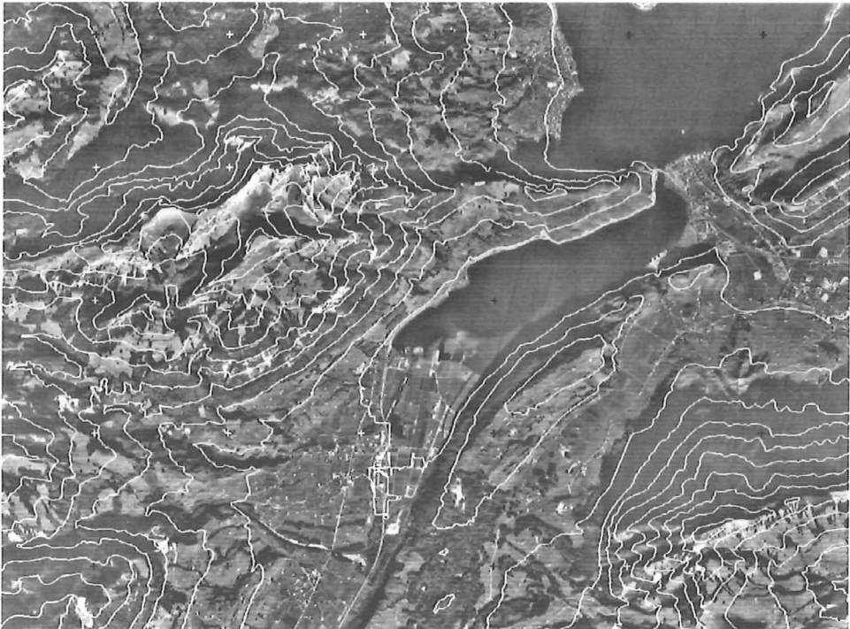
Abb. 7: Ausschnitt aus einem SPOT-Orthobild, überlagert mit Höhenlinien und Gitterkreuzen (DTM: Bundesamt für Landestopographie, Bern)
