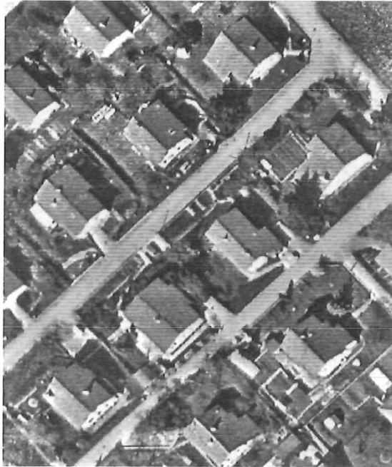
Abb. 10a: Unkorrigiertes Orthobild. Die Häuser erscheinen „umgeklappt“
