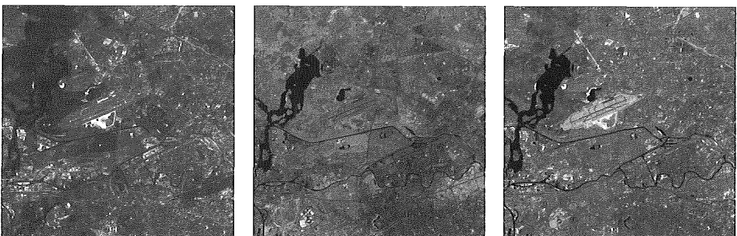
Abb. 6: Multispektrale Bilddaten: Thematic-Mapper-Daten von Berlin in den Kanälen 2 (0,52–0,60 \mu\text{m} ), 4 (0,76–0,90 \mu\text{m} ) und 5 (1,55–1,73 \mu\text{m} )
