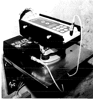
Abb. 6: Laser-Konvergenzmeßsystem mit Datenfernübertragung
