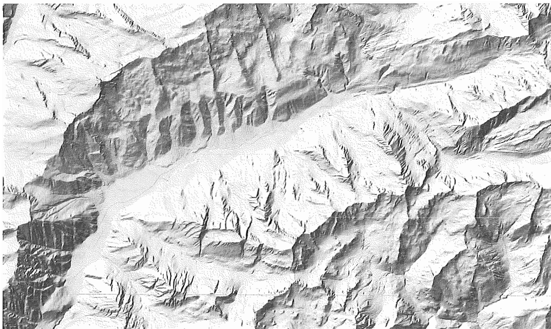
Abbildung 3: Ausschnitt aus dem neu erstellten Geländemodell für den Bereich Südtirol als geschummertes Relief (ca. 15% des gesamten neu erstellten Geländemodells)
