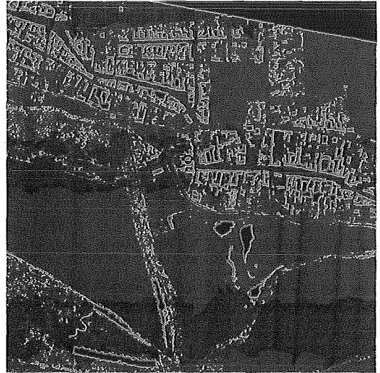
Abb. 12: Dichtemodell der klassifizierten Bodenpunkte aus der digitalen photogrammetrischen Auswertung im Gebiet von Abb. 8a
