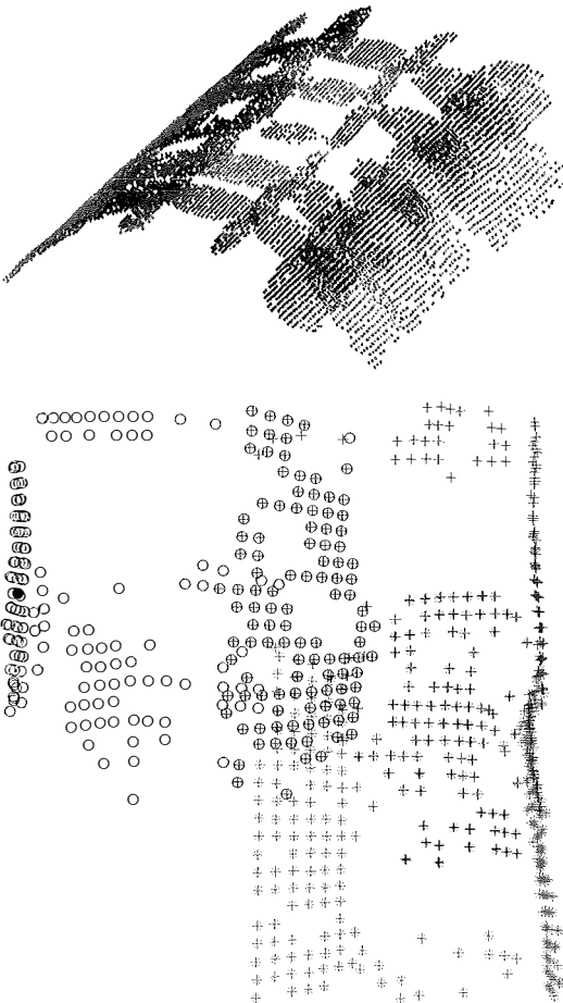
Abb. 4: Simultane Orientierung von 30 gegebenen Punktwolken (oben) mit bekannten Korrespondenzen. Ausschnitt mit 4 Punktwolken welche die überlappenden Bereiche zeigen (unten). Daten mit freundlicher Genehmigung von Gerhard Paar, Joanneum Research Graz.
