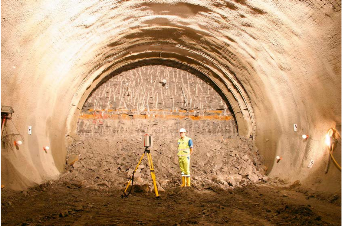
Abb.2: Deformationsbestimmung einer NÖT-Ortsbrust mit TLS (Quelle: Dipl.-Ing. Johannes Ohlmann-Bartusel, Lehrstuhl für Geodäsie, TUM)
