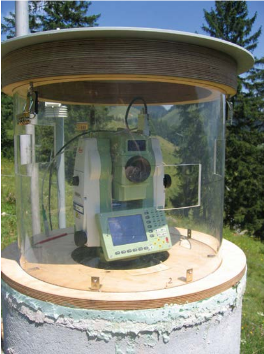
Abb.6: Bildgebender Tachymeter IATS2 beim Rutschhangmonitoring (Quelle: Dr.-Ing. Peter Wasmeier, Lehrstuhl für Geodäsie, TUM)
