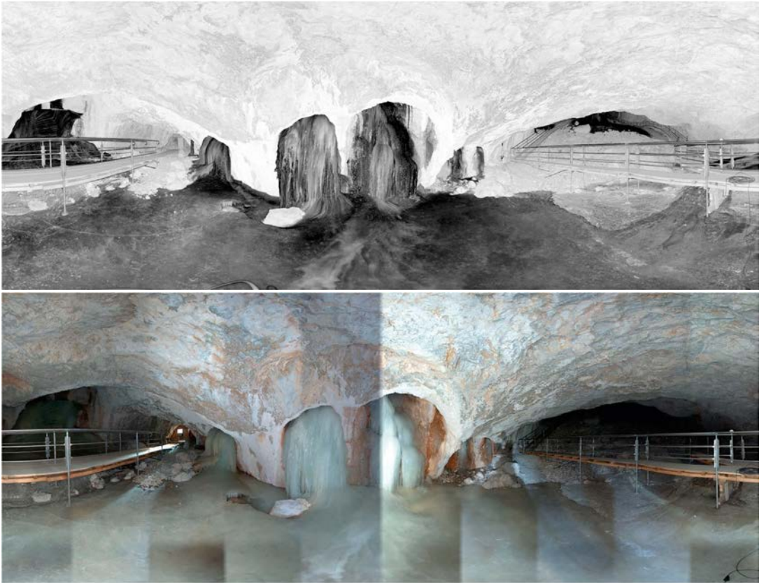
Abb. 2: Abbildung eines TLS-Scans mit dem Faro Photon 20/120 in der äußeren Eisriesenwelt vom 7. April 2010. Oben: Scan-Punktwolke. Unten: Synchron aufgenommenes Digitalfoto zum Drapieren der Bildtextur.
